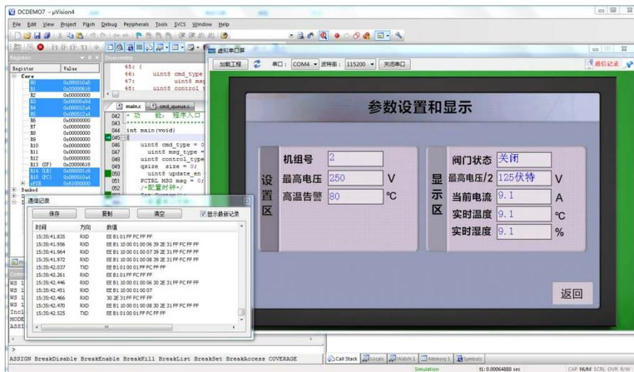
图 7-3 Keil 开发环境与虚拟串口屏绑定调试
