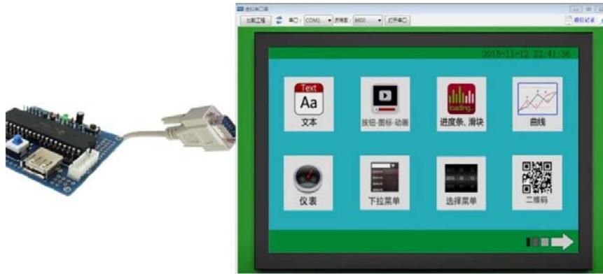
图 7-2 用户单片机串口与“虚拟串口屏”联机调试
