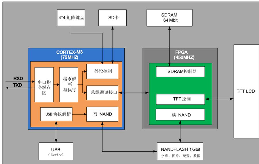
图 6-1 基本型串口屏内部结构图
